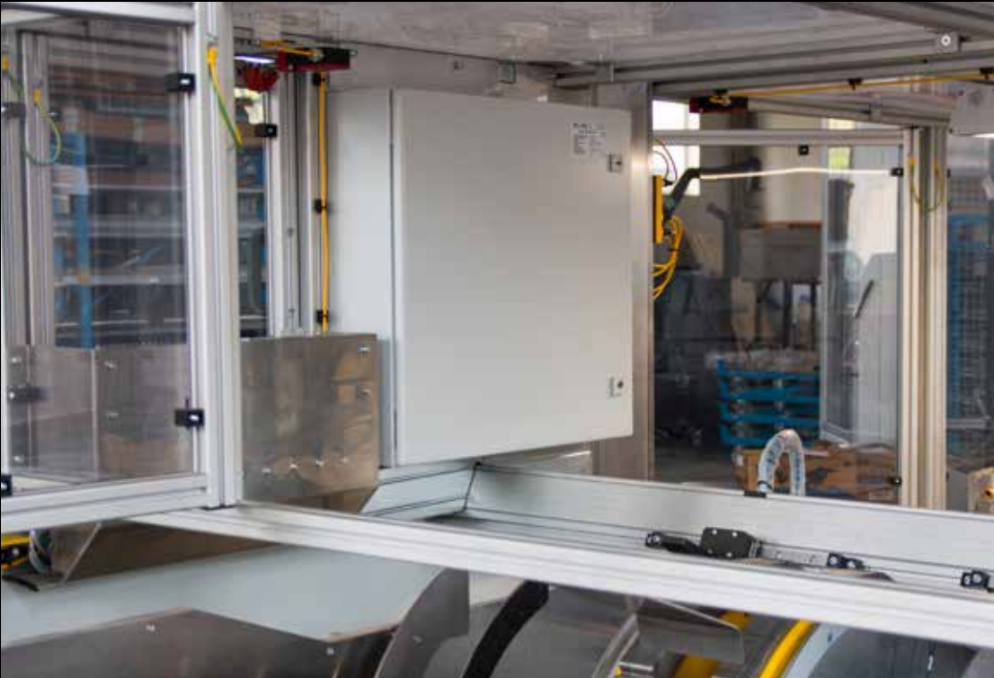
Szinte a teljes Rittal termékpalettát használják: a képen a gépbe épített AE szekrény.
